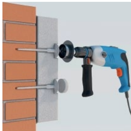
Zápustná montáž skrutkovacej kotvy
