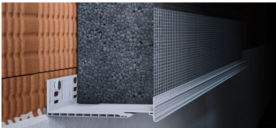
Obr. Základný soklový profil z PVC Ejot Pro pre výrazné zníženie tepelného mosta v soklovej časti. Vysoká rozmerová stálosť, optimálne odvádzanie vody. Kombinácia dvoch dielov je vhodná pre rôzne hrúbky izolantov.
