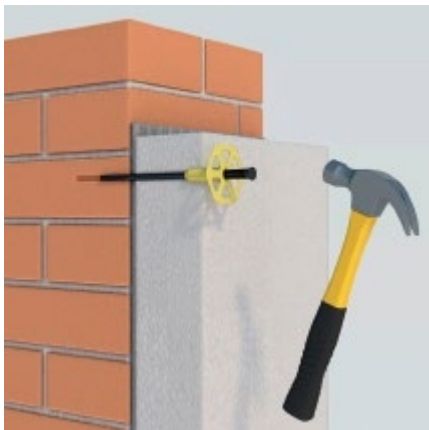
Povrchová montáž zatíkácej kotvy
