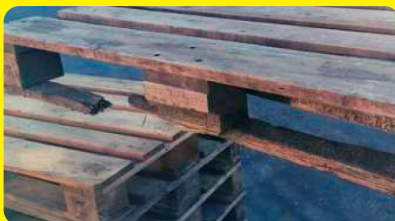
Zle upevnená doska a uvoľnený klinec
