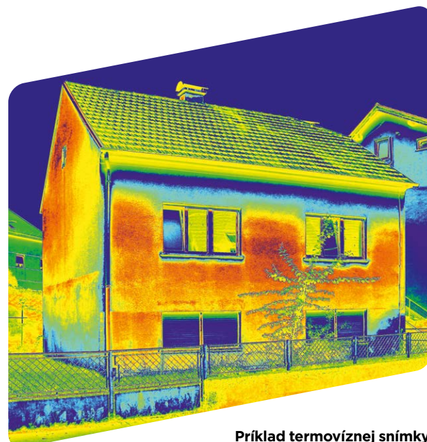
Príklad termovíznej snímky rodinného domu pred zateplením Termovízna snímka fasády domu. Červené a oranžové miesta ukazujú oblasti veľkých tepelných strát, tzv. tepelných mostov. Vonkajším zateplením fasády tieto „slabé miesta“ eliminujeme.
