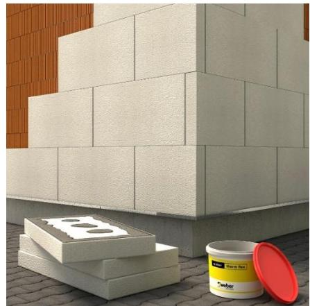
Lepiaca malta sa nanáša ručne alebo strojovo na tepelnú izoláciu celoobvodovo, kde hrúbka pásu je 10 - 20 mm, šírka pásu min. 50 mm. Do stredu platne sa aplikujú minimálne dva terče veľkosti dlane. Lepiaca malta musí tvoriť minimálne 40% z celkovej plochy povrchu dosiek z fenolovej peny spojených s podkladom.
