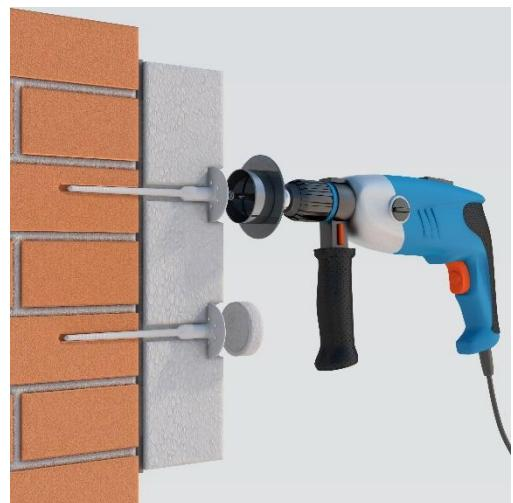
Ak je rozperná kotva zle osadená, deformovaná alebo inak poškodená a pokial' je to možné sa odstráni (zvyšný otvor sa vyplní tepelnoizolačným materiálom a výstužnou maltou) a nahradí novou vedľajšou rozpernou kotvou v jej blízkosti.
