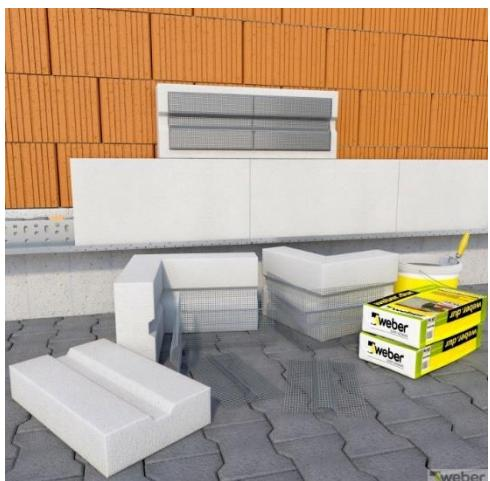
Drážky v zateplňovacích systémoch možno vykonať osadením vopred vyrobených drážkových dielov. Vydrážkované diely sa vkladajú medzi izolačné dosky zateplňovacieho systému. Vydrážkovaný diel je vytvorený z pásu tepelnej izolácie, do ktorej je vrezaná drážka. Povrch lícnej strany drážkového profilu je povrchovo upravený základnou vrstvou.
