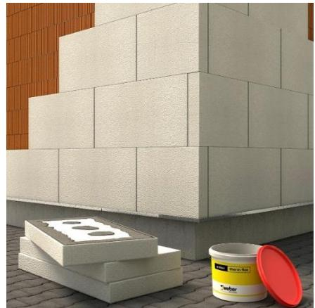
Lepiaca malta sa nanáša ručne alebo strojovo na tepelnú izoláciu celoobvodovo, kde hrúbka pásu je 10 - 20 mm, šírka pásu min. 50 mm. Do stredu platne sa aplikujú minimálne dva terče veľkosti dlane. Lepiaca malta musí tvoriť minimálne 40% z celkovej plochy povrchu dosiek z EPS spojených s podkladom.
